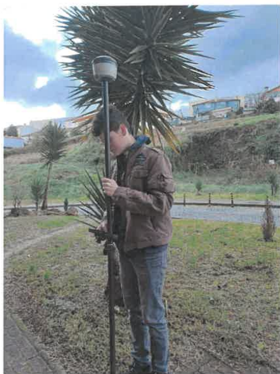
9. kép Pontok állandósítása GNSS vevő és HILTI szegek segítségével
