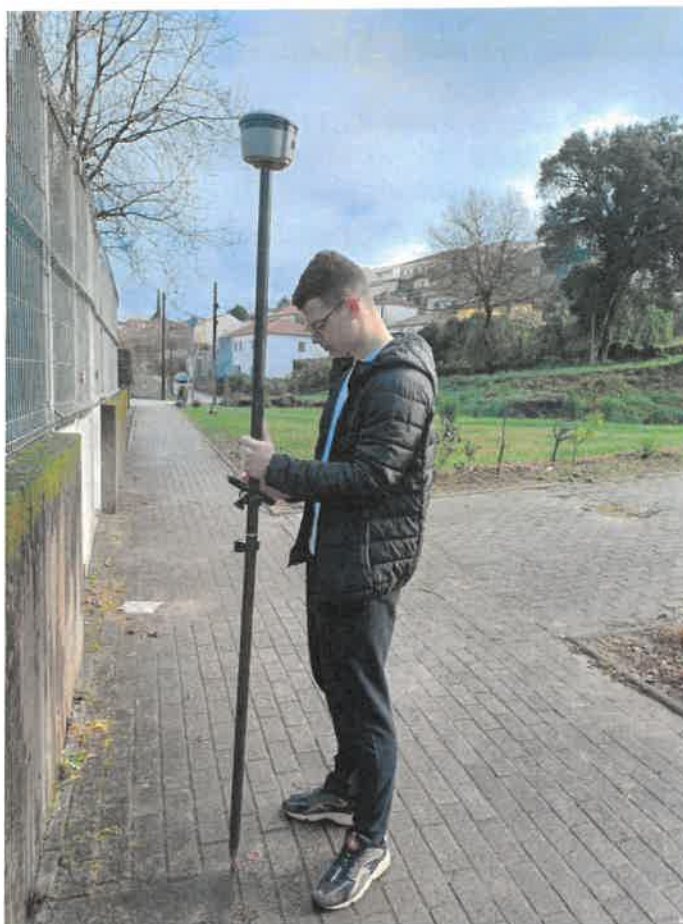
Mérés a Trimble R2-vel
